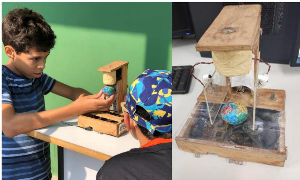
Figuras 2 e 3. Levitador Eletromagnético experimental. Ano: 2023. Fonte: acervo do CEAM/AHS.
