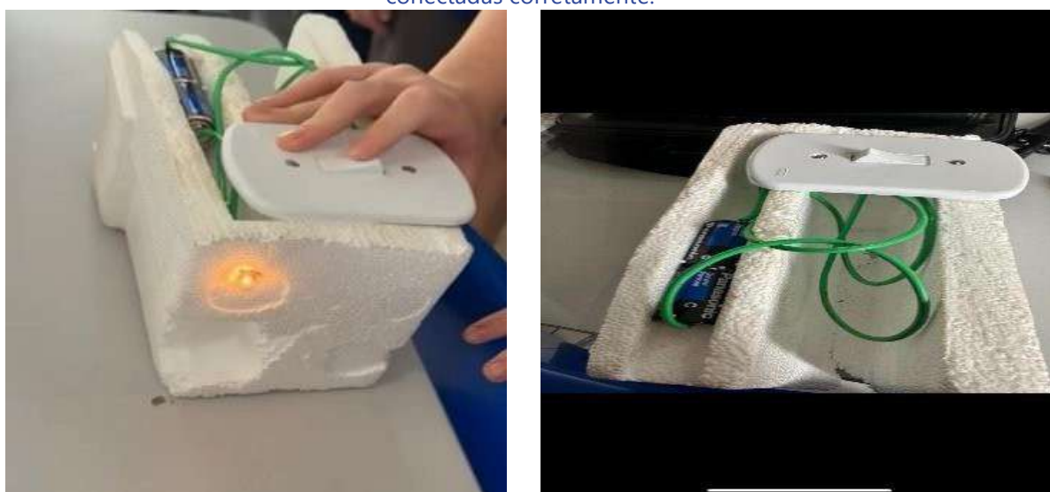
Figura 1 e 2 - Demonstração do circuito em série: as lâmpadas acesas mostram quando todas estão conectadas corretamente.
